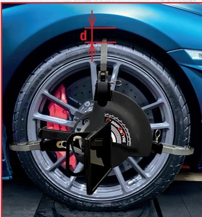
Para la instalación típica del producto es necesario que la distancia "d" entre el neumático y el pasarueda sea como mínimo de 30 mm.
