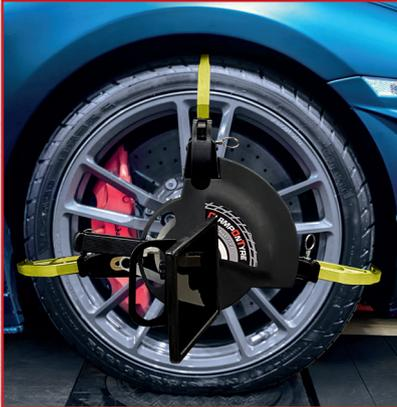
La peculiaridad de la nueva garra ClampOnTyre es que no toca la llanta, enganchándose en el neumático mediante tres soportes moldeados como se evidencia en la figura siguiente.
